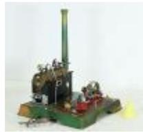
**372.** Märklin, machine à vapeur horizontale sur socle peint en vert à chauffage à alcool, avec piston latéral entraînant une roue de transfert de mouvements.
